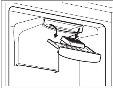
3. Setzen Sie den neuen Luftfilter in den Schlitz ein.
