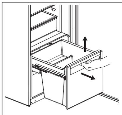
2. Schieben Sie die Schienen in das Gerät, um eine Beschädigung des Geräts beim Schließen der Tür zu verhindern.
