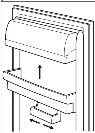
Dieses Modell ist mit einem variablen Lagerfach ausgerüstet, das sich seitlich verschieben lässt.
