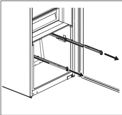
2. Setzen Sie den hinteren Teil der Schublade (1) auf die Schienen.
