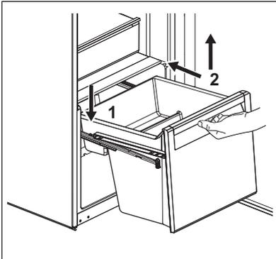
3. Heben Sie den vorderen Teil der Schublade (2) an, während Sie sie hineinschieben.
